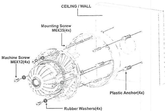
Figure 1. Installation Conduit Adaptor Kit
